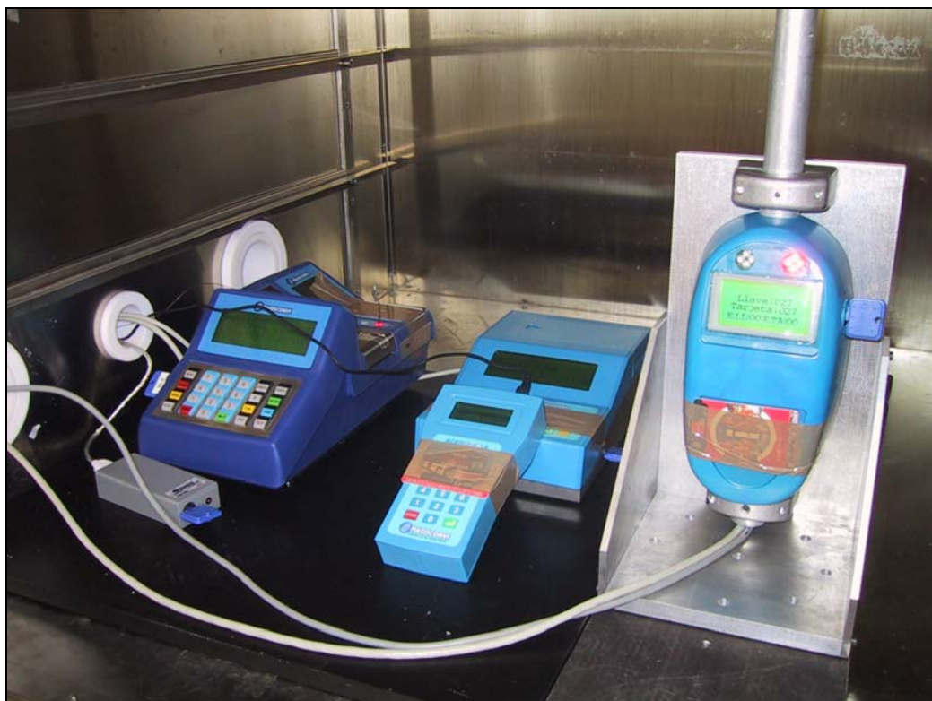
Fotografía 1.- Disposición de las muestras en la cámara climática para los ensayos.
